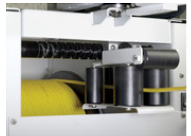
IBAK KW 305 mit automatischer Kabelführung
