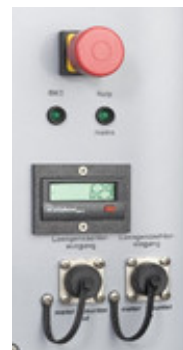
IBAK KW 180 mit Längenmessanzeige und -ausgang
