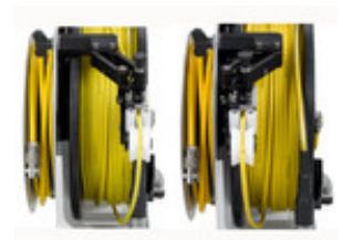
IBAK KT 180, verstellbare Kabelführung
