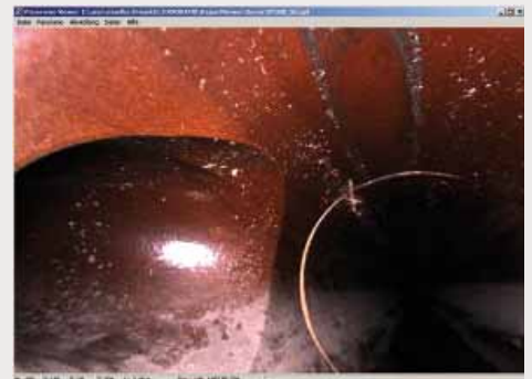
Bild 7: Perspektivische Ansicht eines schadhaften Stützens
