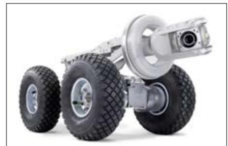
▲ ORPHEUS am KRA 75 mit ZSW und Traktorreifen
