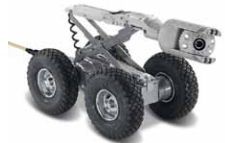
IBAK KRA 85 mit großen Luftreifen, elektrischem Kamerалift und ARGUS 5 Kamera
