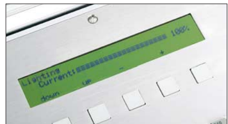
IBAK BK3 integriertes Display für Kamera und KRA Daten und Setup Einstellungen
