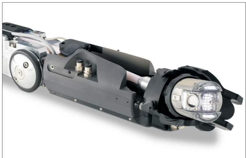
LISY-System mit ORION Kamera für Hausanschlussuntersuchung (1993/2003)
