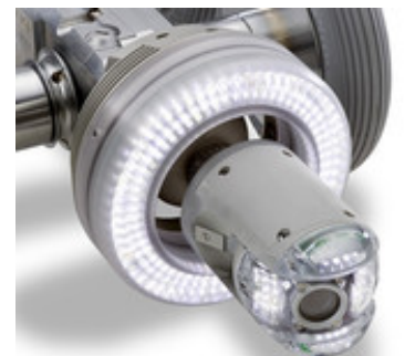
IBAK ORION mit integriertem Ortungssender und Zusatzscheinwerfer ZSW 65 für Rohre > DN 600
