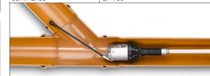
1. ORION sur jonc pousseur, avec dispositif de guidage à roulettes
