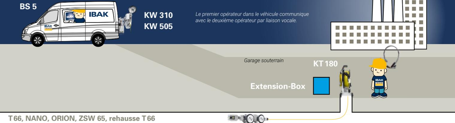
Les équipements modulaires IBAK portables et utilisables en poussée peuvent être raccordés aux véhicules d'inspection IBAK par le biais du kit d'extension. Il est ainsi possible d'inspecter les tronçons et les conduites difficiles d'accès à partir du véhicule. L'ensemble du logiciel destiné aux rapports et l'appareil d'enregistrement sont donc également à disposition dans le véhicule pour l'utilisation en poussée. L'ali-
