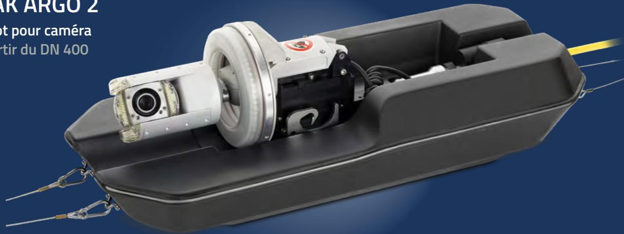
Le canot pour caméra **IBAK ARGO 2** a été spécialement conçu pour les canalisations de grandes dimensions parfois partiellement remplies d'eau. Le corps flottant est sécurisé par un câble tracteur. Ainsi, l'inspection est rendue possible dans le sens ou contre le sens de l'écoulement de l'eau.
