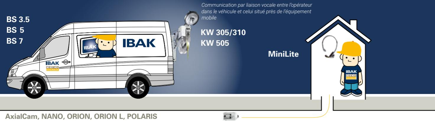
Extension pour inspection en tractée avec le système de commande BS 5
