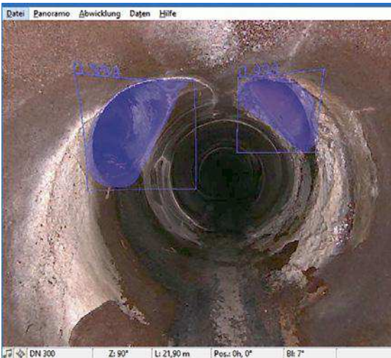
Abb. 2: Links: Durch Maskierungen (lila dargestellt) visualisierte Anschlüsse, die das Softwaretool ArtIST in einem für das KI-System unbekanntem Film als solche mit Hauptkode und Charakterisierung erkannt hat. Rechts: Maskierungen auf der Panorama-Abwicklung für den schnellen Überblick über die gesamte Untersuchung.
