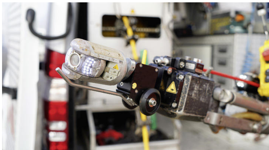
Mit dem Kamera-Adapter für den MicroGator nutzt KSM alle Vorteile der Dreh- und Schwenkkopfkamera Orion, ohne dazu ein Inspektionsfahrzeug vor Ort zu binden. | Fotos: IBAK
