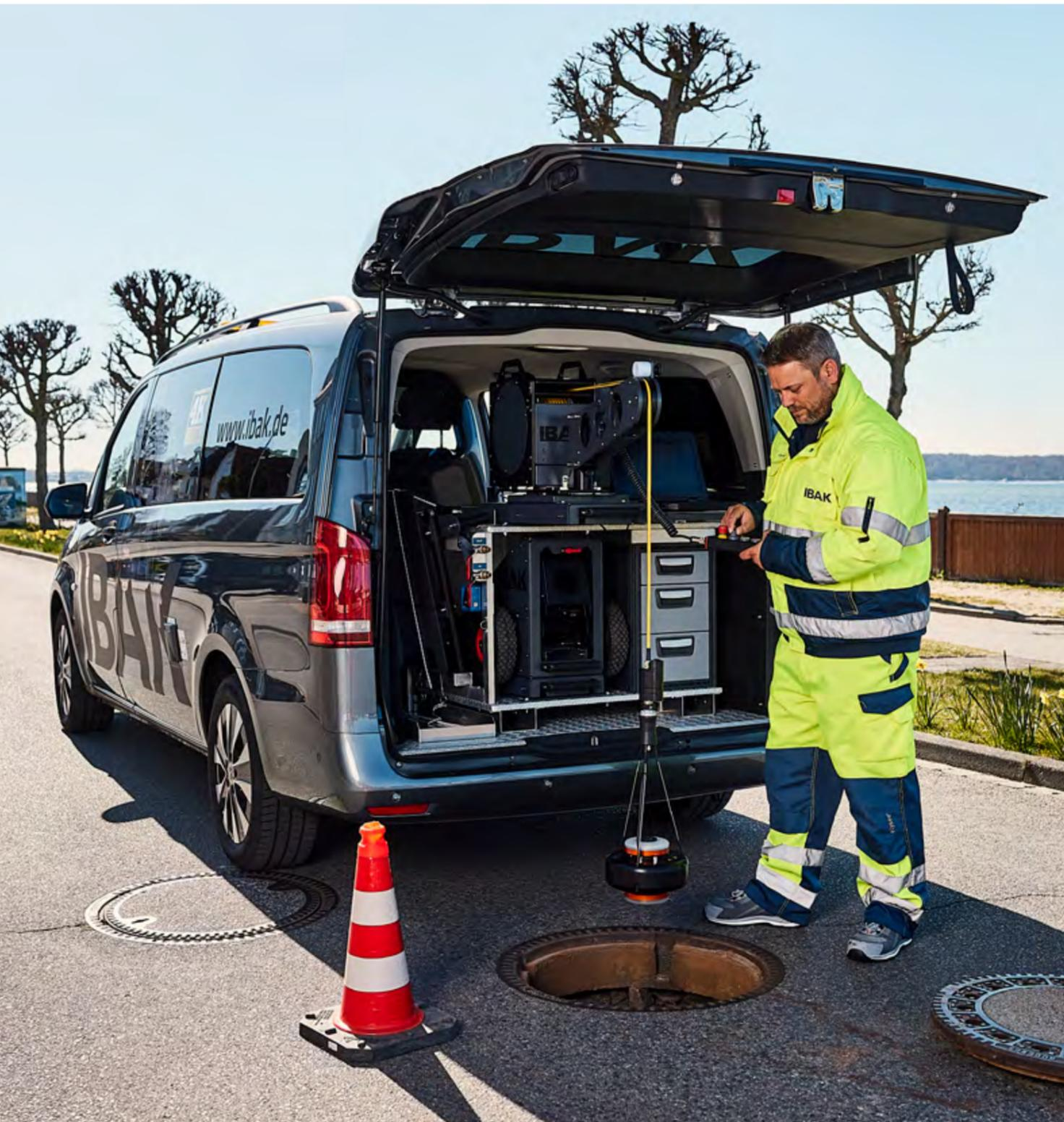
Le système d'inspection des regards Panoramio SI 4K délivre des prises de vue 3D à ultra-haute résolution et des données de mesure précises.
