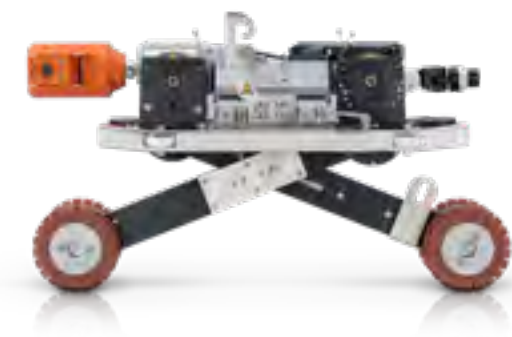
T 76 avec rehausse de chariot universel • à partir du DN 650 • Dispositif pour tuyaux ovoïdes DN 400 - DN 140 • avec pneus 4,0 et double extension
