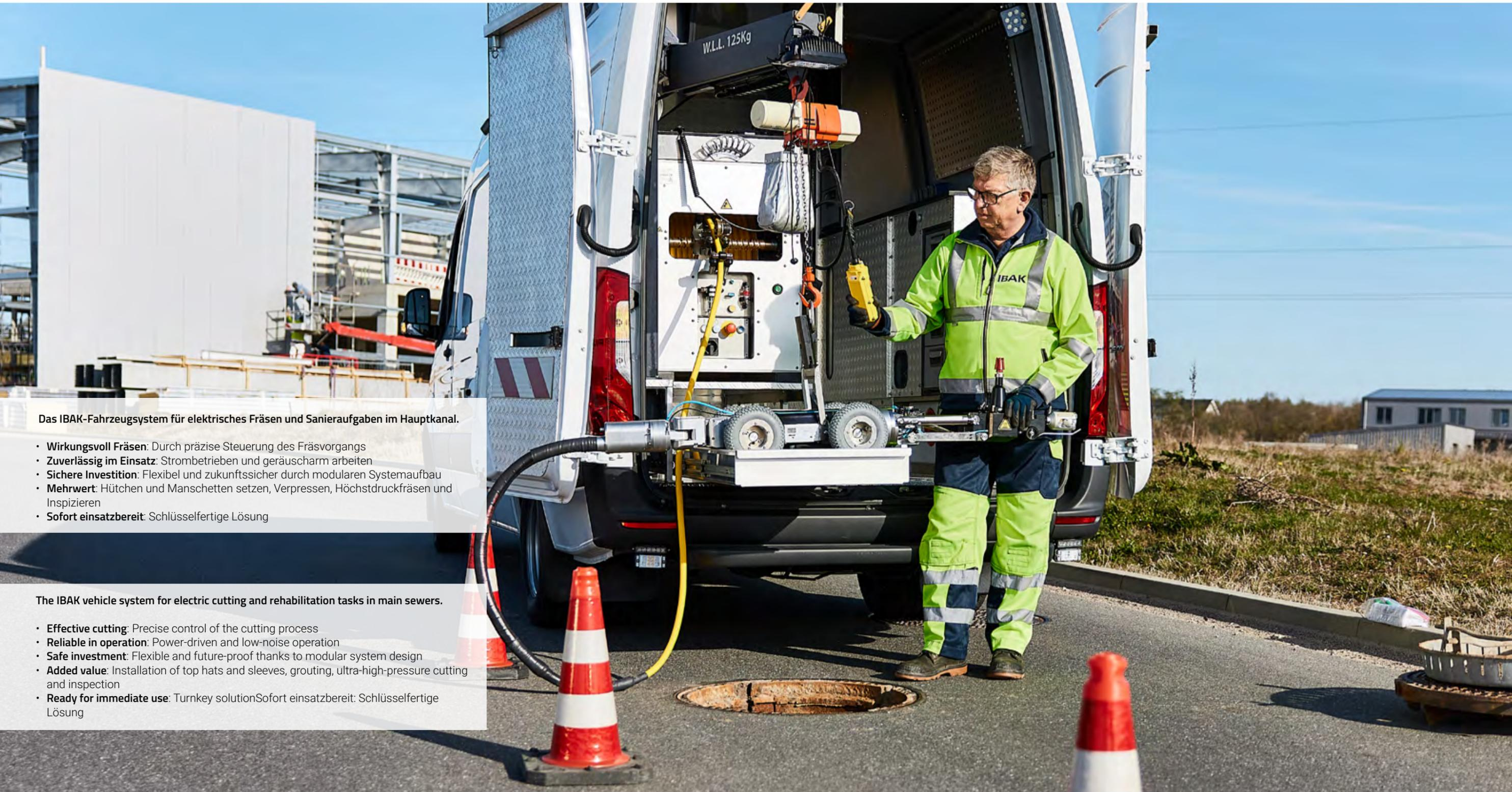
Das IBAK-Fahrzeugsystem für elektrisches Fräsen und Sanieraufgaben im Hauptkanal.
