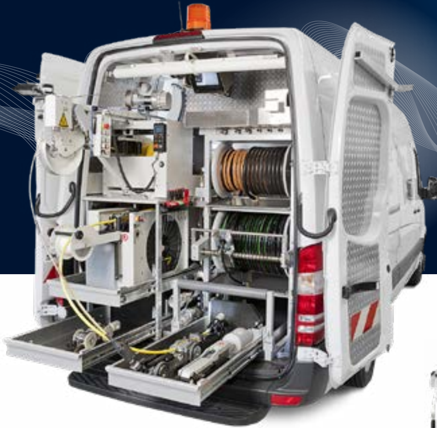
IBAK PHOBOS 4 angeschlossen an LISY- Spülpaket
