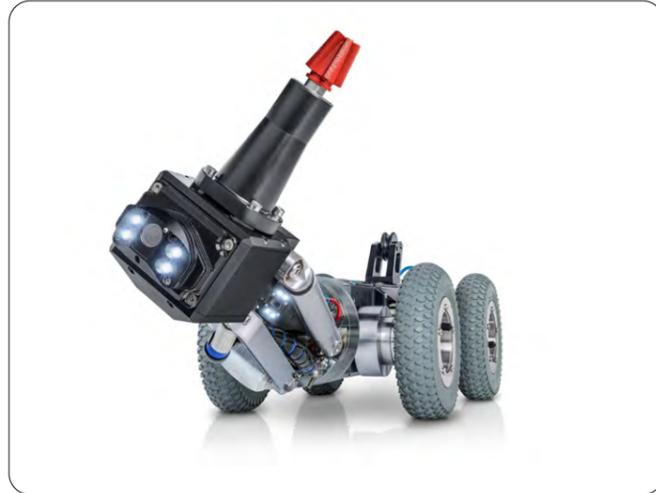
Das IBAK-Fahrzeugsystem für elektrisches Fräsen und Sanieraufgaben im Hauptkanal.
