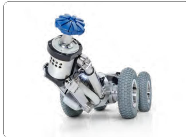
Système IBAK pour le fraisage pneumatique et les tâches de réhabilitation dans le collecteur principal.
