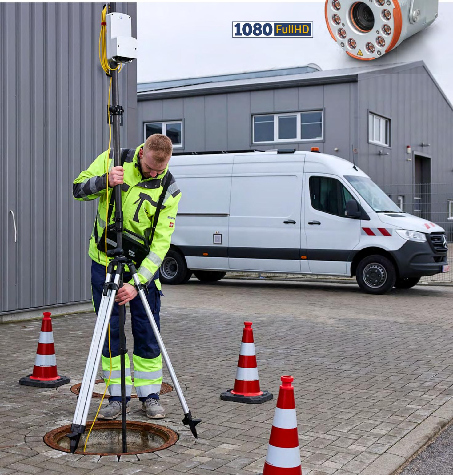
Die ASPECTA ermöglicht die schnelle Zustandserfassung und Bewertung von Abwasserleitungen aus einem angrenzenden Schacht.
