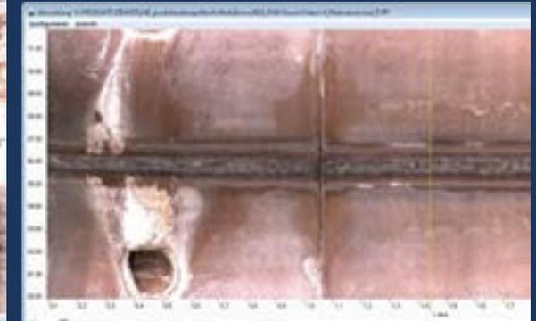
Für eine schnelle Übersicht ist es möglich, sich die Abwicklung des Rohres anzeigen zu lassen.
