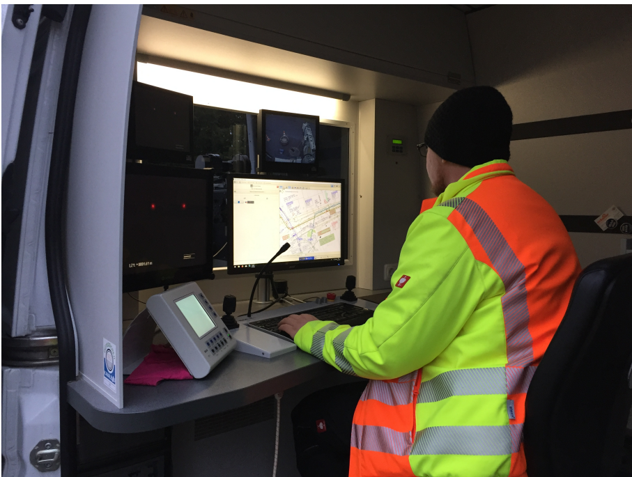
Bildunterschrift: Die Ergebnisse der LaserScan-Deformationsvermessung mittels Dreh- und Schwenkkopfkamera ORPHEUS 2 werden grafisch am Monitor im TV-Fahrzeug veranschaulicht.
