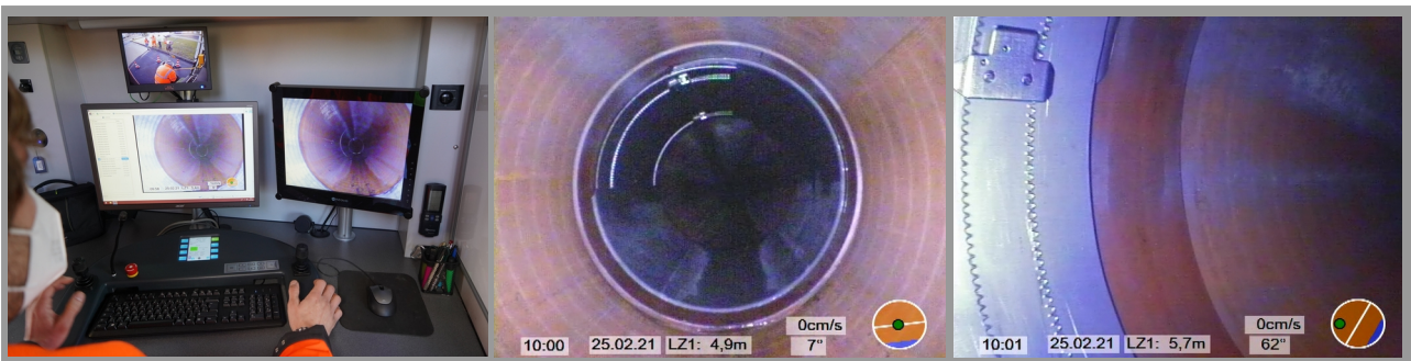
Bildunterschrift (DSC02696.jpg; 210531_ORION_Aufnahme_01.jpg; 210531_ORION_Aufnahme_02.jpg) Der Inspektionskamera-Adapter ermöglicht den Betrieb einer ORION-Kamera am MicroGator. Fräsroboter und Inspektionskamera werden mit der gleichen Bedienung im Sanierungsfahrzeug gesteuert.
