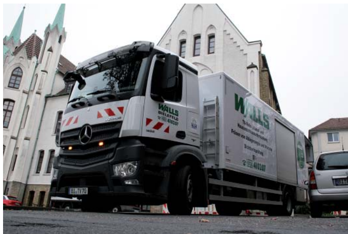
Die IBAK Helmut Hunger GmbH & Co. KG realisierte in Zusammenarbeit mit der MÜLLER Umwelttechnik GmbH & Co. KG ein kombiniertes Saug- und Spülfahrzeug mit integrierter Kanalrohrinspektionstechnik.
