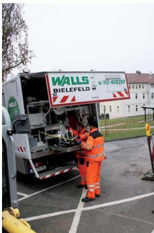
Da im Heckraum des 19-Tonnners die Kanalrohrinspektionstechnik der IBAK Helmut Hunger GmbH & Co. KG untergebracht ist, wird die quer eingebaute Schlammkammer seitlich entleert.
