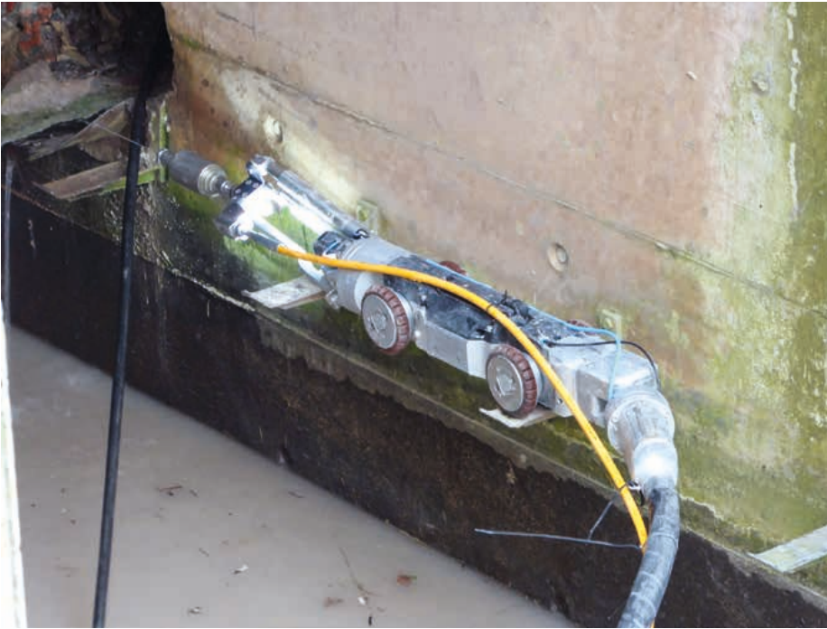
Eine drehbar gelagerte Falch-Höchst-Druck-Wasserstrahldüse kann über eine kipp-, schwenk- und neigbare Werkzeuganbindung an dem MicroGator-Geräteträger unter Kamerabeobachtung kontrolliert durch Kanalrohre gesteuert werden. | Foto: IBAK
